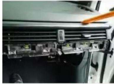
24. Entfernen Sie die Luftauslassblende
