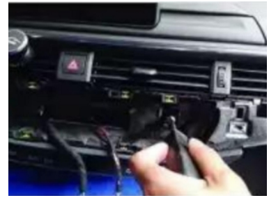
18. Entfernen Sie die Befestigungsschrauben
