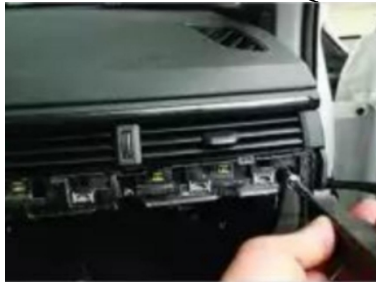
17. Entfernen Sie die Zierleiste unter dem Originalbildschirm
