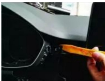
28. Hebeln Sie die Instrumententafel vorsichtig mit einem Hebelwerkzeug an und nehmen Sie den Originalbildschirm heraus
