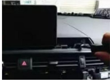
21. Entfernen Sie die Befestigungsschrauben
