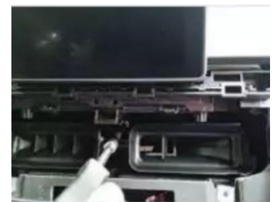
27. Entfernen Sie die Befestigungsschrauben des Originalbildschirms.
